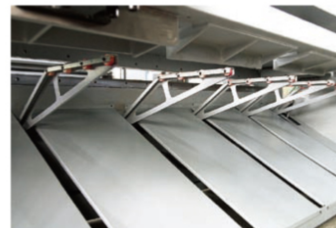
Positioning pneumatic sheet support Positionnement du support pneumatique
