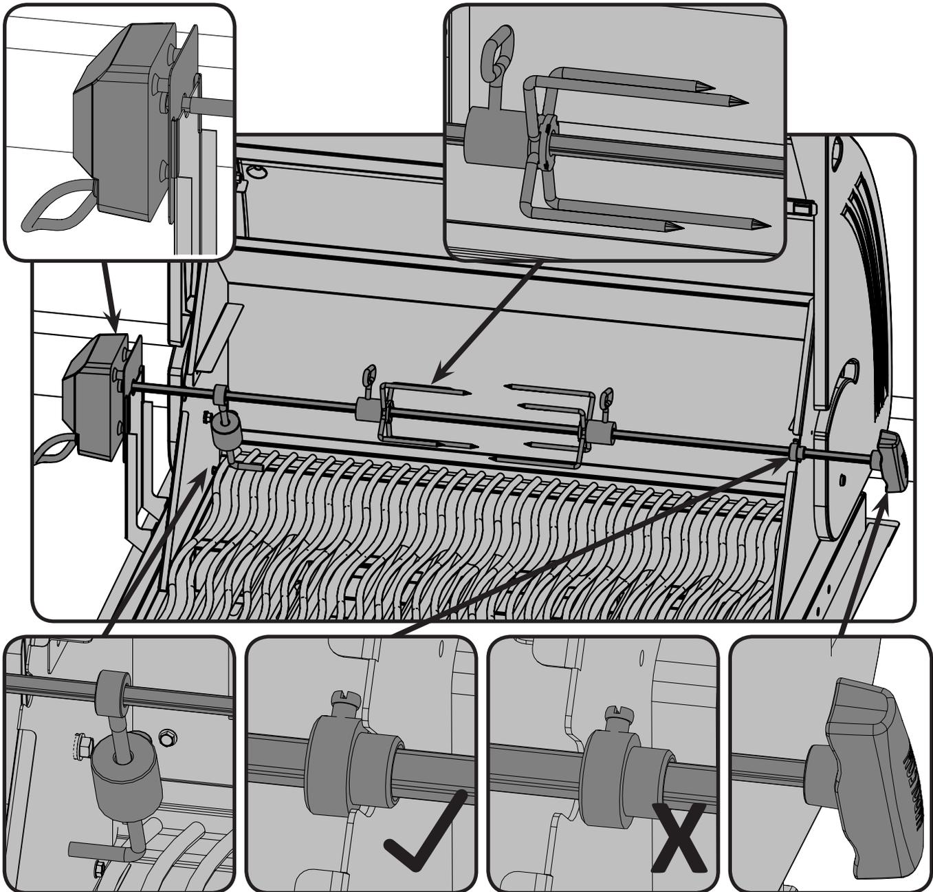
Sicherstellen, dass die Anschlagbuchse an der Innenseite des Haubengussteils fest angezogen ist.
