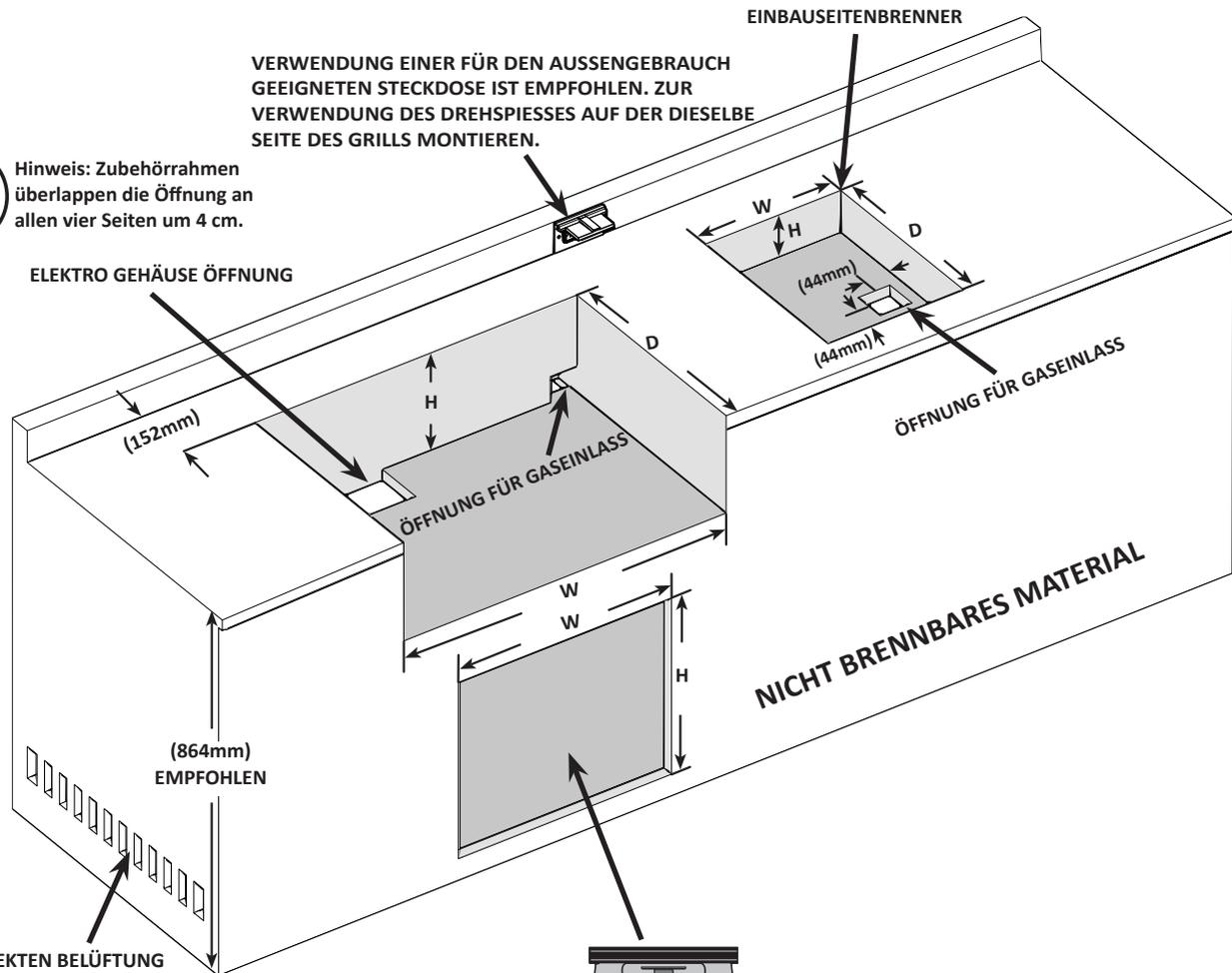
ZUR KORREKTEN BELÜFTUNG MUSS EIN MINDESTQUERSCHNITT VON 65 cm<sup>2</sup> AN ALLEN SCHRANKENDEN EINGEHALTEN WERDEN.
