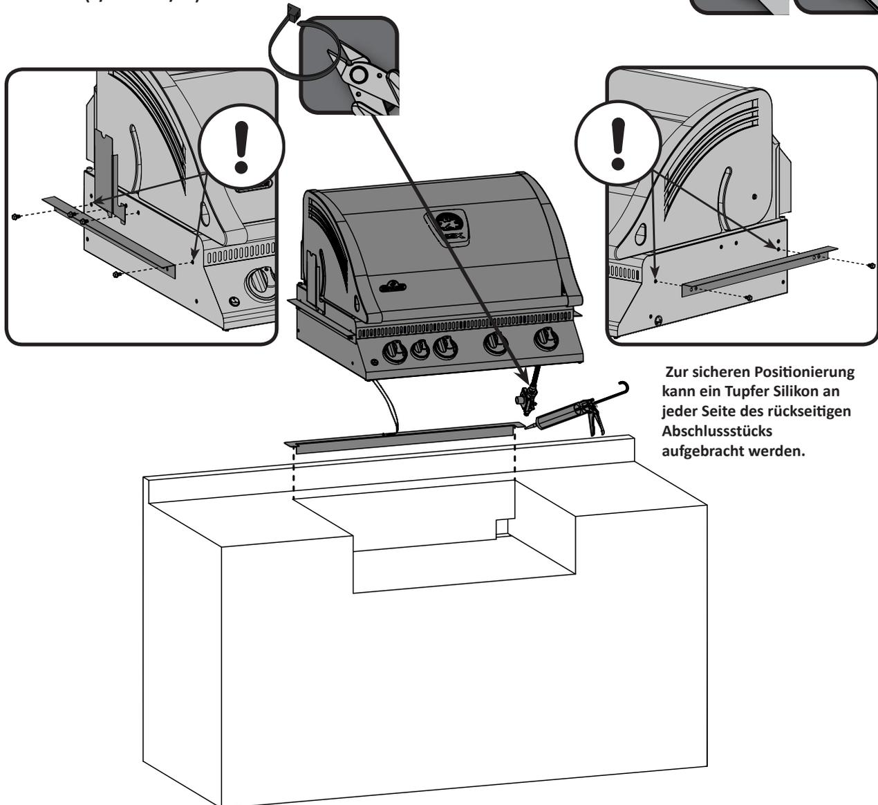
Zur sicheren Positionierung kann ein Tupfer Silikon an jeder Seite des rückseitigen Abschlussstücks aufgebracht werden.
